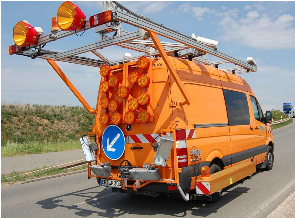
Messfahrzeug STIER der Firma LEHMANN + PARTNER, Erfurt
