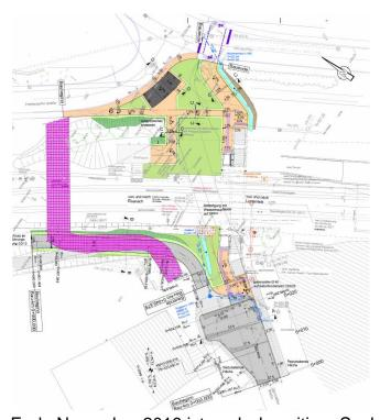
Die Firma Züblin, Bayreuth ist im Zeitplan. Die Betonarbeiten für die Unterführung im Gleisbereich sind abgeschlossen. Es werden nun die Aufzugschächte und die Treppenanlagen betoniert. Nach Einbau des Schachtgerüstes werden die werksmäßig vorgefertigten Aufzüge im Oktober eingebaut.
